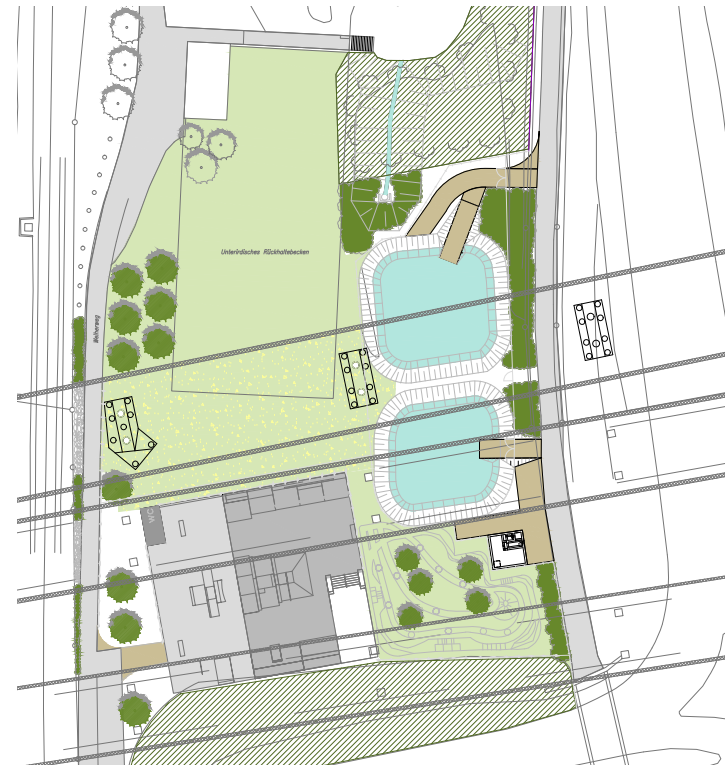
Unterirdisches Ölrückhaltebecken, Retentionsmulden und Rollsportanlage
